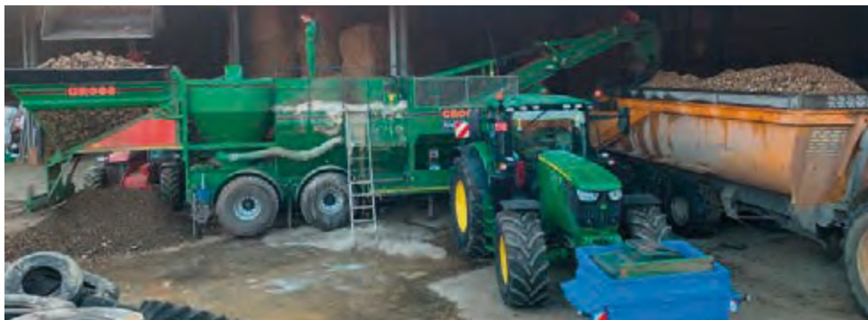
© J.Pezon La laveuse épiereuse de betteraves Cross modèle éléphant lave les racines dans un tambour à eau cylindrique. Elles sont ensuite acheminées par un tapis jusqu'à une fraise. L'entraînement se fait par un tracteur pour un débit annoncé jusqu'à 100 t/h.
